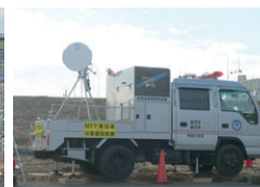
11GHz帯を使用して最大容量150Mbpsで2016ch伝送可能な災害対策機器新11P-150M
